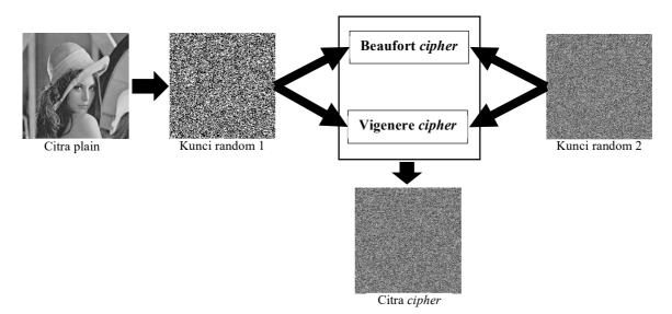
Gambar 2. Proses enkripsi yang diusulkan
